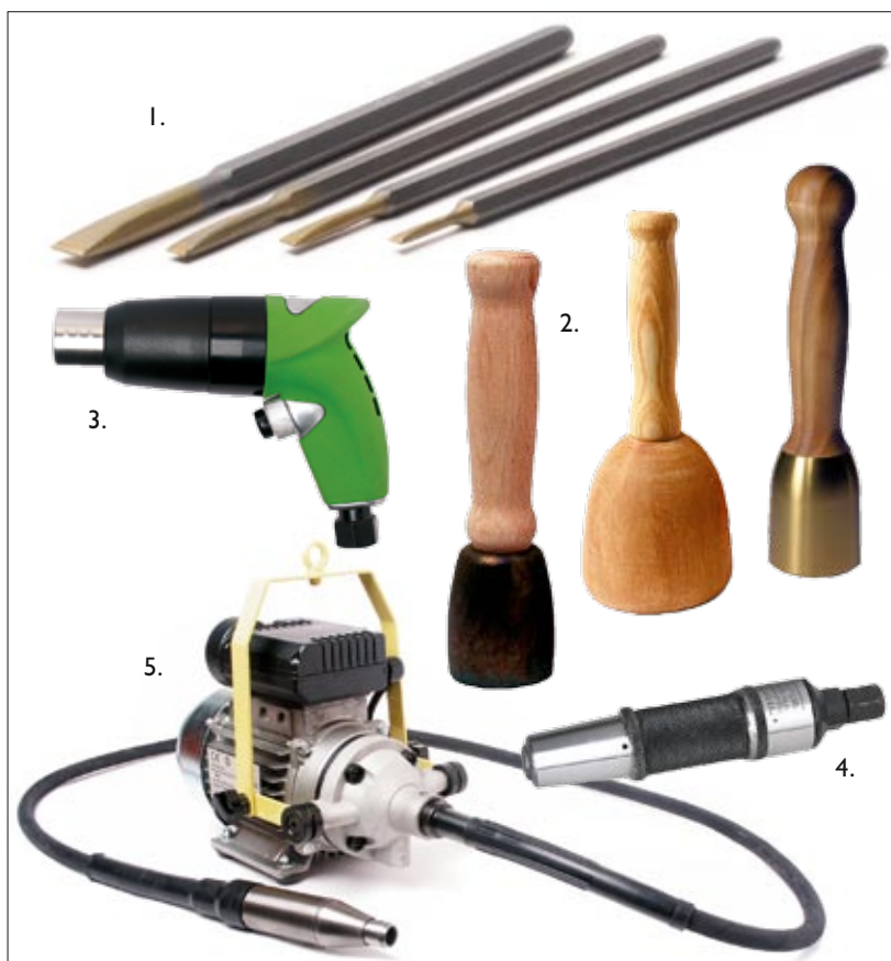
Narzędzia służące do wykuwania napisów: 1 - dłuta, 2 - pobijaki różnego typu (stalowe, drewniane, mosiężne), 3, 4 - dłuta pneumatyczne, 5 - dłuto elektryczne
