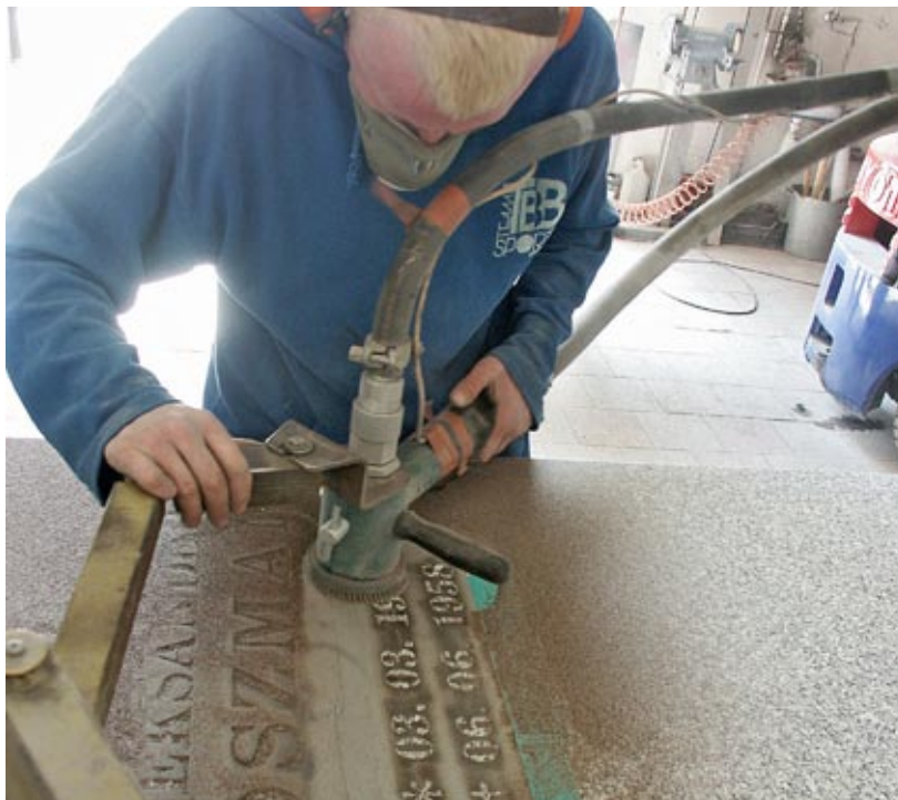
Wykonywanie napisu piaskarką bezpyłową prowadzoną ręcznie
